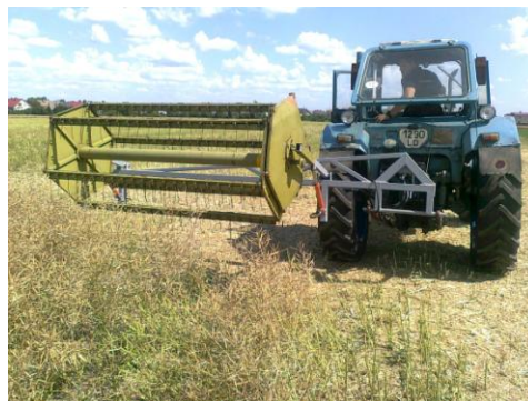
1 pav. Kombaino lenktuvų įrenginys rapsų sėklų nuostolių nustatymui Fig. 1. The device for investigation of rape seed loss due to reel of combine harvester
